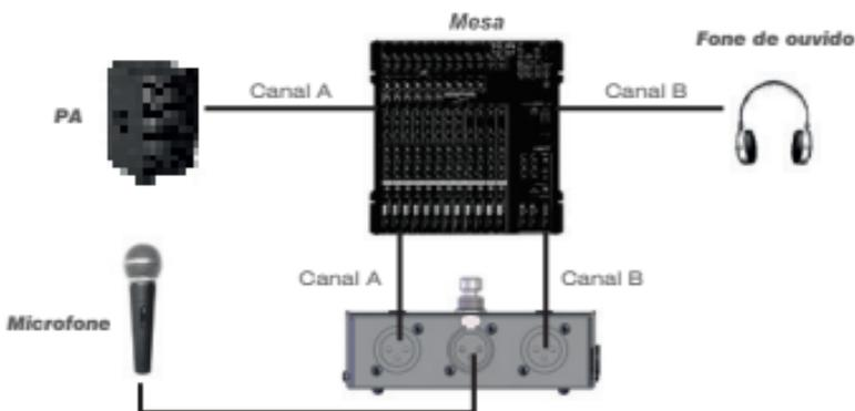
A entrada do microfone está naturalmente ligada no canal A. Ao pressionar o footswitch (**e mantê-lo pressionado**) ocorrerá a mudança de sinal para o canal B. **Liberando o footswitch**, o sinal retornará automaticamente para o canal A. A mesa de som enviará o sinal de saída dos canais conforme foram programados nela. **Veja a imagem de exemplo acima:** Fone de ouvido (Canal B) e PA (Canal A).
