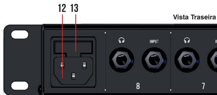
**12.ENTRADA AC** – Este equipamento é Bi-volt podendo ser energizado com uma tensão de 100-240v 50/60Hz;
