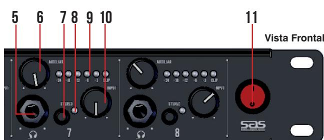
**6.VOLUME AUXILIAR** – Controle de volume livre de ruídos e interferências, permitindo o ajuste do volume auxiliar para o canal;
