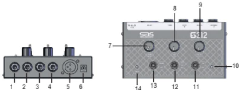
1. INSTRUMENT IN – Entrada de alta impedância (desbalanceada) compatível com qualquer fonte de áudio;
