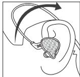
Fone deve ser inserido conforme imagem para uso correto, confortável e melhor desempenho de isolamento acústico.
