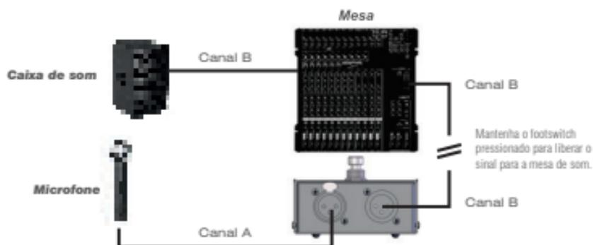
Ao pressionar o footswitch (**e mantê-lo pressionado**) o sinal para o canal B será liberado. **Soltando o footswitch**, o sinal retornará automaticamente para o canal A (sendo mutado). A mesa de som, vai direcionar a saída do Canal B conforme for programada. **Veja o exemplo da imagem acima:** O sinal do canal B é direcionado para caixa de som quando é liberado pelo footswitch.
